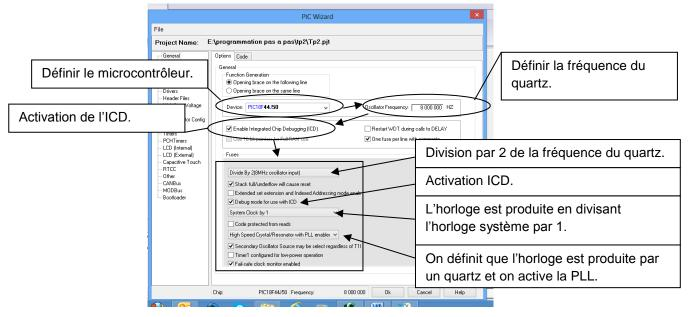
Remarque : pour avoir plus de détails sur la configuration de l'horloge, il faut se référer à la notice technique du circuit PI18F44J50. Ici la configuration est prête pour utiliser l'USB en mode haute vitesse.
