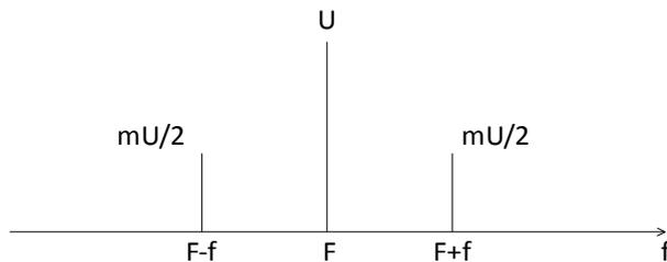
3. Chacune des composantes est sinusoïdale, pour obtenir la puissance instantanée normalisée on les élève au carré et comme la valeur moyenne d'un sinus (ou cosinus) carré vaut 1/2, on obtient pour la porteuse  $U^2/2$  et pour les raies latérales  $m^2 \cdot U^2/8$  soit une puissance totale de  $U^2/2 + m^2 \cdot U^2/4$ .
