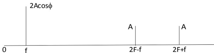
3. La fréquence de coupure du filtre passe-bas est choisie de manière à éliminer les pulsations proches de  $2\Omega$ . Représenter le spectre de  $v_s(t)$ .
