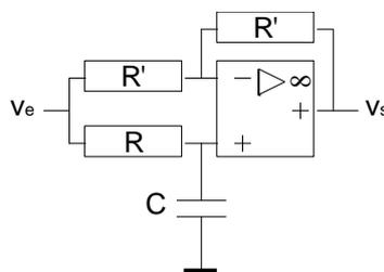
4. La fréquence du signal BF varie en réalité entre 100 Hz et 10 kHz. Calculer le déphasage créé par le circuit à ces deux fréquences.
