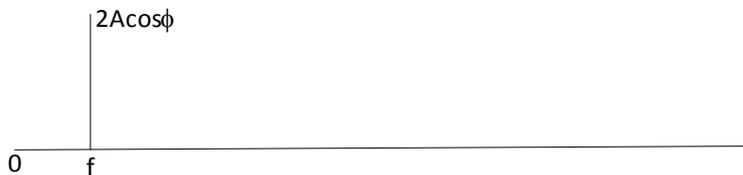
4. Le signal démodulé est atténué par le  $\cos \varphi$  et peut s'annuler si  $\cos \varphi = 0$
