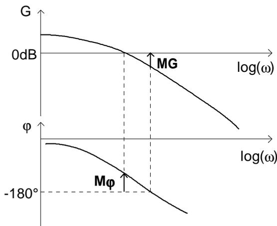
C-7.b  $\omega = 600 \text{ rad/s}$   $M\phi = 78,6^\circ$ , la stabilité est suffisante.
