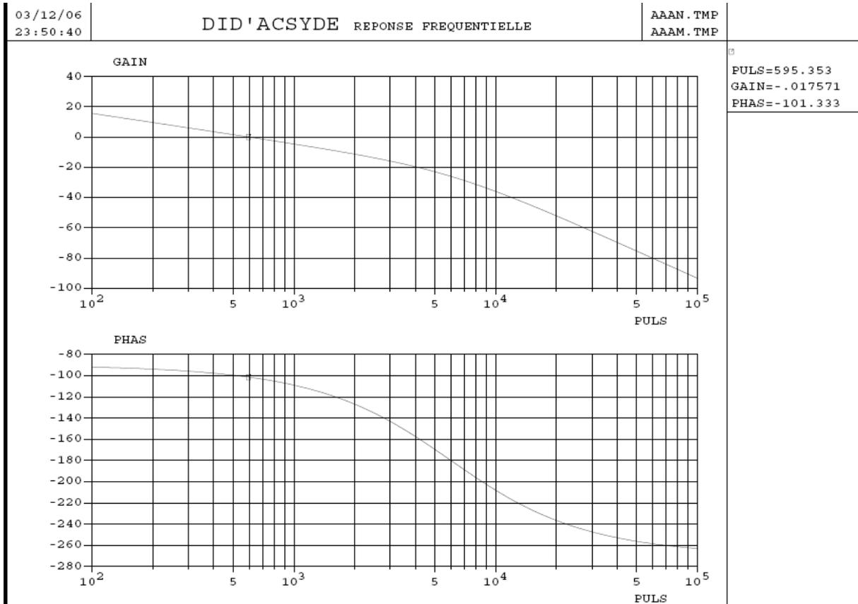
Un système est stable en boucle fermée si, pour un argument de  $-180^\circ$  de la FTBO le gain est inférieur à 0 dB. Les marges de gain et de phase sont déterminées ainsi sur la FTBO :
